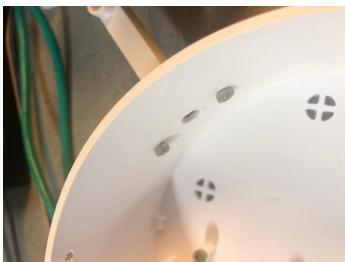
Wenn keine weiteren Sensoren verwendet werden, kann man das Deckplate verwenden, um die Löcher zu verschließen.
